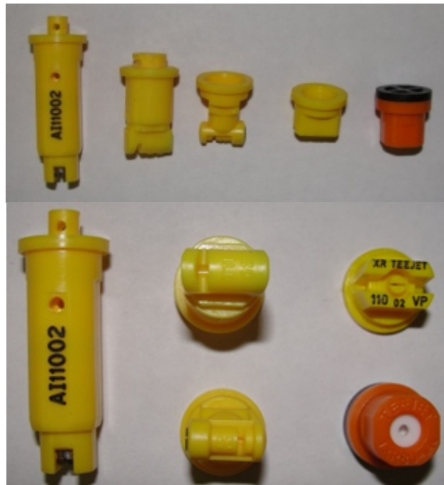
Figura 20. Boquillas a emplear en el trabajo. De izquierda a derecha: Aire Inducido (AI), Turbo Inducido (TTI), Turbo (TT), Rango Extendido (XR), Cono Hueco (TXR).
